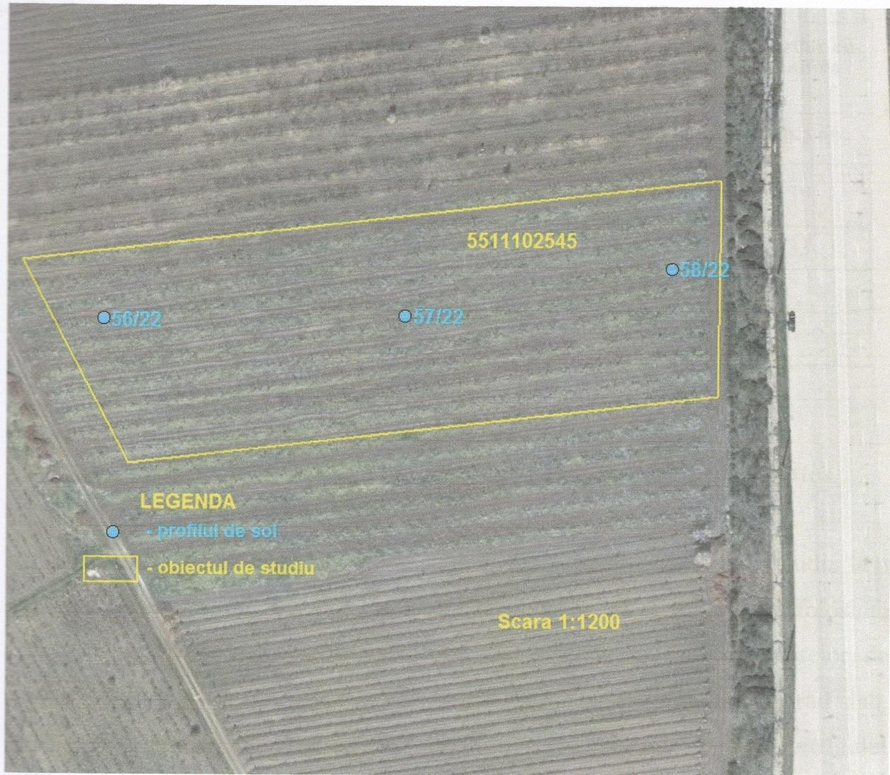
Figura 2. Amplasarea spațială a pichetului geodezice pentru profilul de sol
